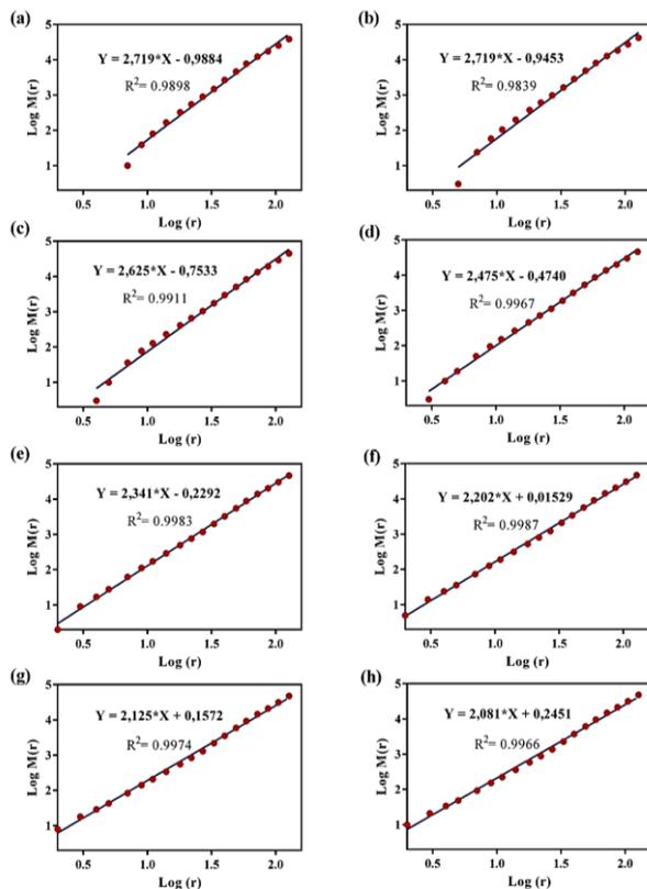
**Figure 8.** Benoit FD's outputs of the grayscale binary images displayed in Figure 7. (a)  $v_{air}=200\Omega.m$ , (b)  $v_{air}=220\Omega.m$ , (c)  $v_{air}=240\Omega.m$ , (d)  $v_{air}=260\Omega.m$ , (e)  $v_{air}=280\Omega.m$ , (f)  $v_{air}=300\Omega.m$ , (g)  $v_{air}=320\Omega.m$ , (h)  $v_{air}=340\Omega.m$ .
