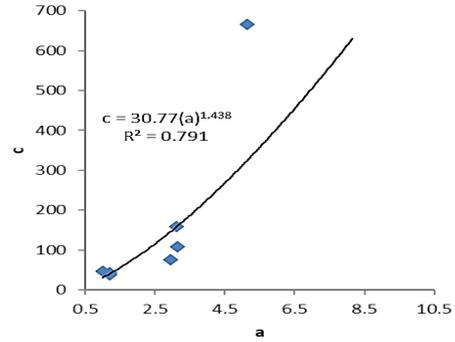
Fig. 11. exponent  $c$  and factor  $a$  parameters of Swebrec
