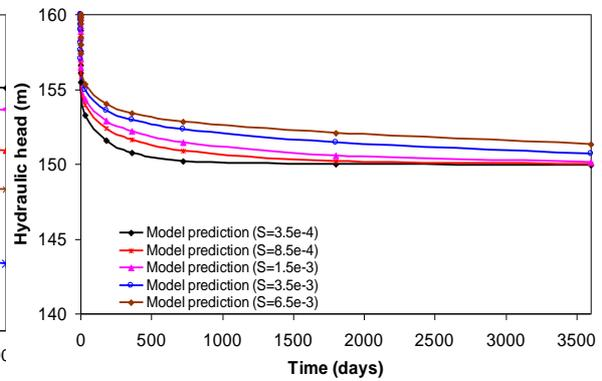
(d) Hydraulic head vs time for different storage coefficient
